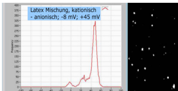
Zetapotentialverteilung, direkt im Laser Streulicht Video Mikroskop gemessen
