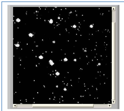
Links: Mischung aus 420 nm und 1000 nm Latex- Partikeln
